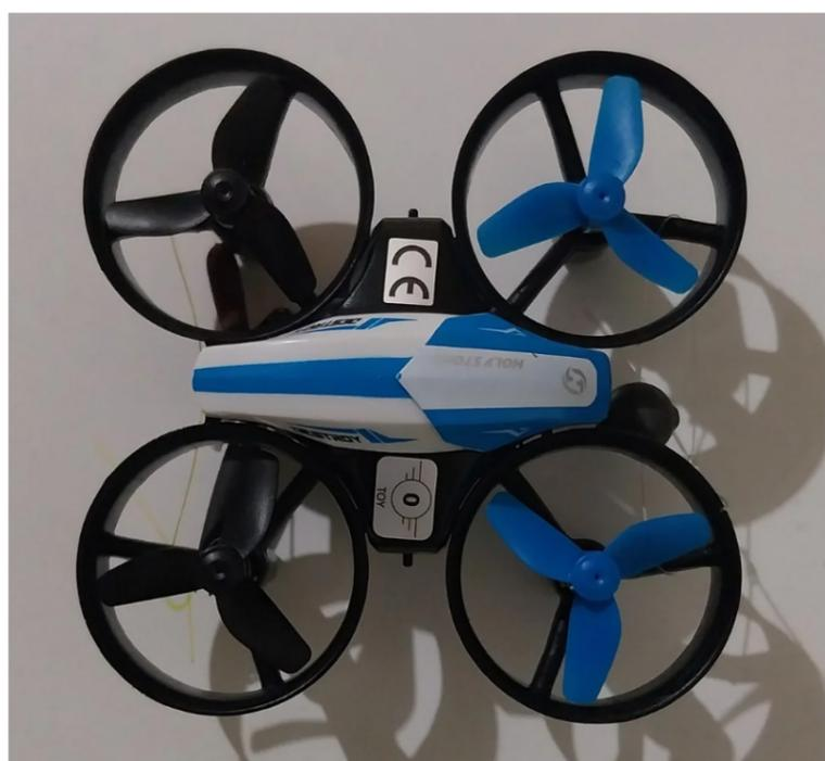
Quando l'uccello vola, batte le ali verso il basso esercitando una forza sull'aria. Secondo il Terzo Principio della Dinamica (azione e reazione), l'aria a sua volta esercita una forza uguale e contraria verso l'alto sull'uccello, permettendogli di librarsi. Nel nostro esperimento il drone esercita una forza sull'aria dentro la scatola. L'aria sostiene il drone con una forza uguale e opposta. Poichè la somma di queste due forze è zero, la forza totale sulla bilancia rimane invariata.
